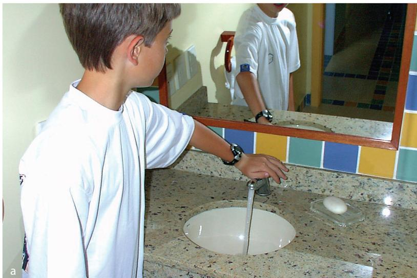
Fig.7a. A presença de torneiras com sistema de pressão ou automático não exigem força e coordenação motora, facilitando seu uso para crianças, para pessoas idosas, ou com artrite. Fig.7b. Degraus muito altos representam desconforto para todos, dificultam o deslocamento de pessoas idosas, gestantes e crianças, além de impedirem a mobilidade de pessoas com muletas e cadeira de rodas.
